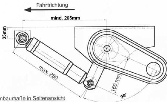
Einbaumaße in Seitenansicht bei unbelasteter Achsschwinge!
